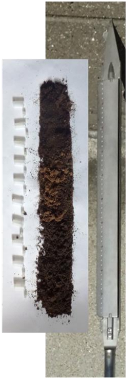
I moserne på Agerse tages boreproveri op til 5 m's dybde. Jordboret er fremstillet af Jan-Ole Nielsen på RUC. Ved en skrap kemisk ætsning i Lis Højhnd Pederssens laboratorium på RUC står pollenkornene tilbage.
