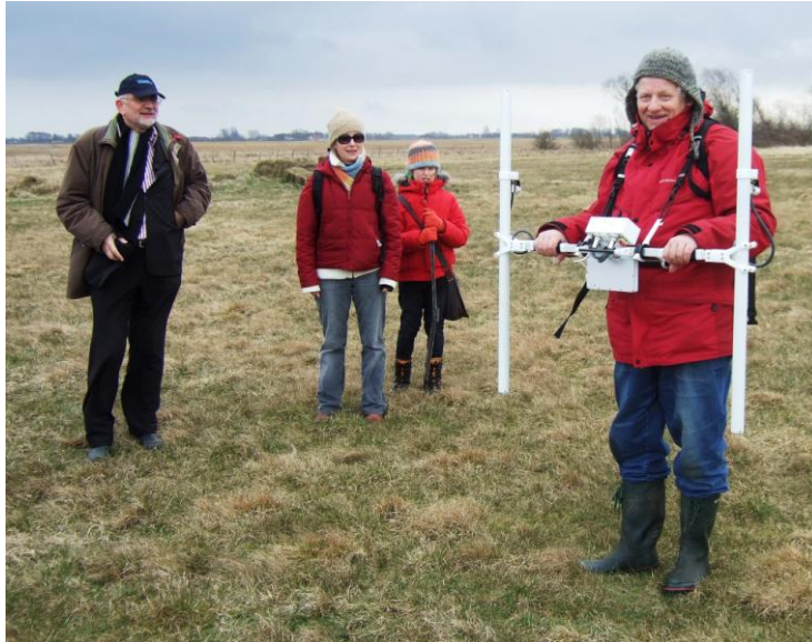
Figur 3. Barringtons dual flux-gate magnetometer GRAD 601/2 i funktion. Det er muligt at få et indtryk af de magnetiske anomalier blot ved at vandre over marken. Men systematiske målinger i et rastermønster er naturligvis afgørende for at se sammenhængende detaljer.
